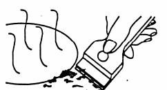
Commencer par passer un chiffon mouillé sur les souillures incrustées et les débordements pour les ramollir. Ensuite, enlever le reste avec un racloir spécial vitrocéramique.
